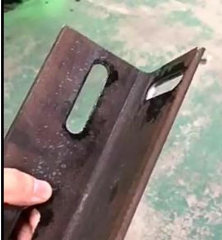
**Допустимый** диапазон отклонения геометрии угла также указан в стандарте, как правило, включая изгиб, ширину кромки, толщину кромки, угол при вершине, теоретический вес и т. Д., И указывает, что стальной угол не должен иметь значительного скручивания.
