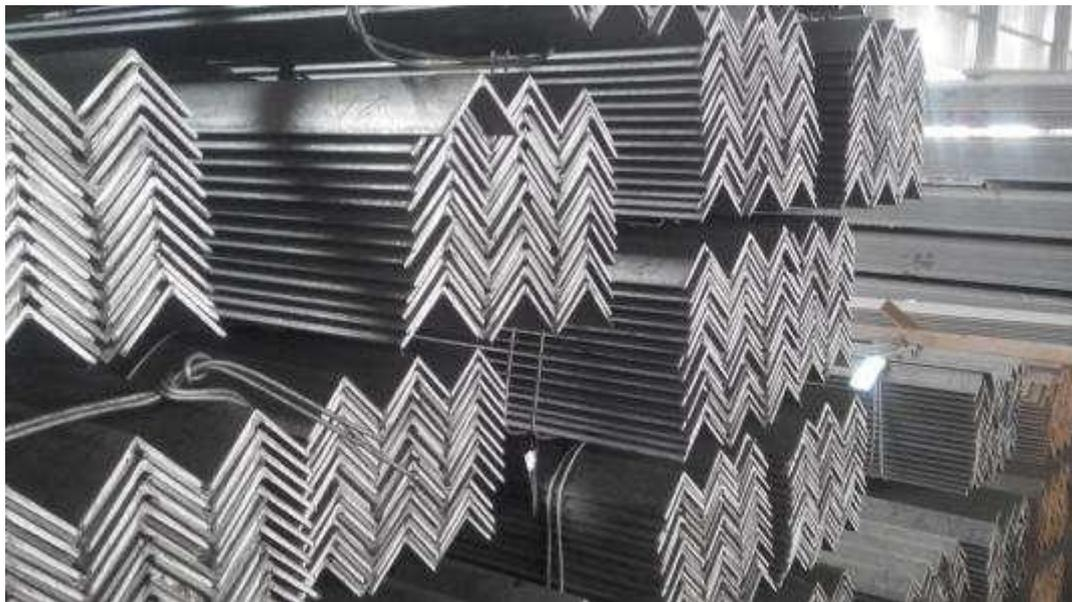
**Угловая** сталь – это углеродистая конструкционная сталь для строительства. Это стальной профиль простого сечения, в основном используемый для каркаса
