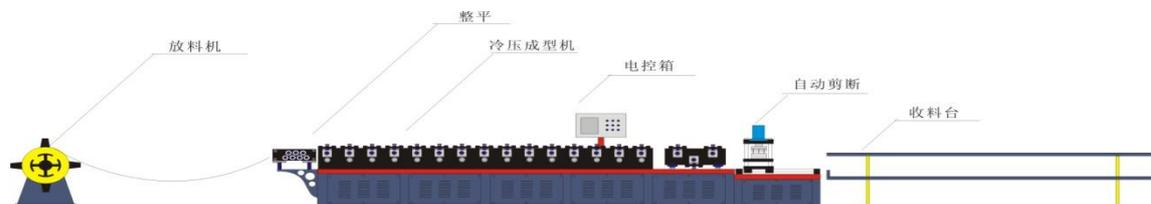
Устройство: разматыватель 、 Направляющее устройство 、
