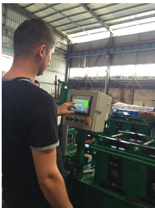
(一). Линия формовки металла Кнопка управления и ручное управление
